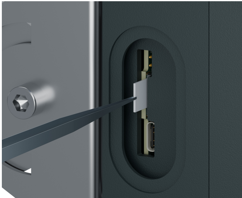
SIM-Karte entnehmen und einsetzen
